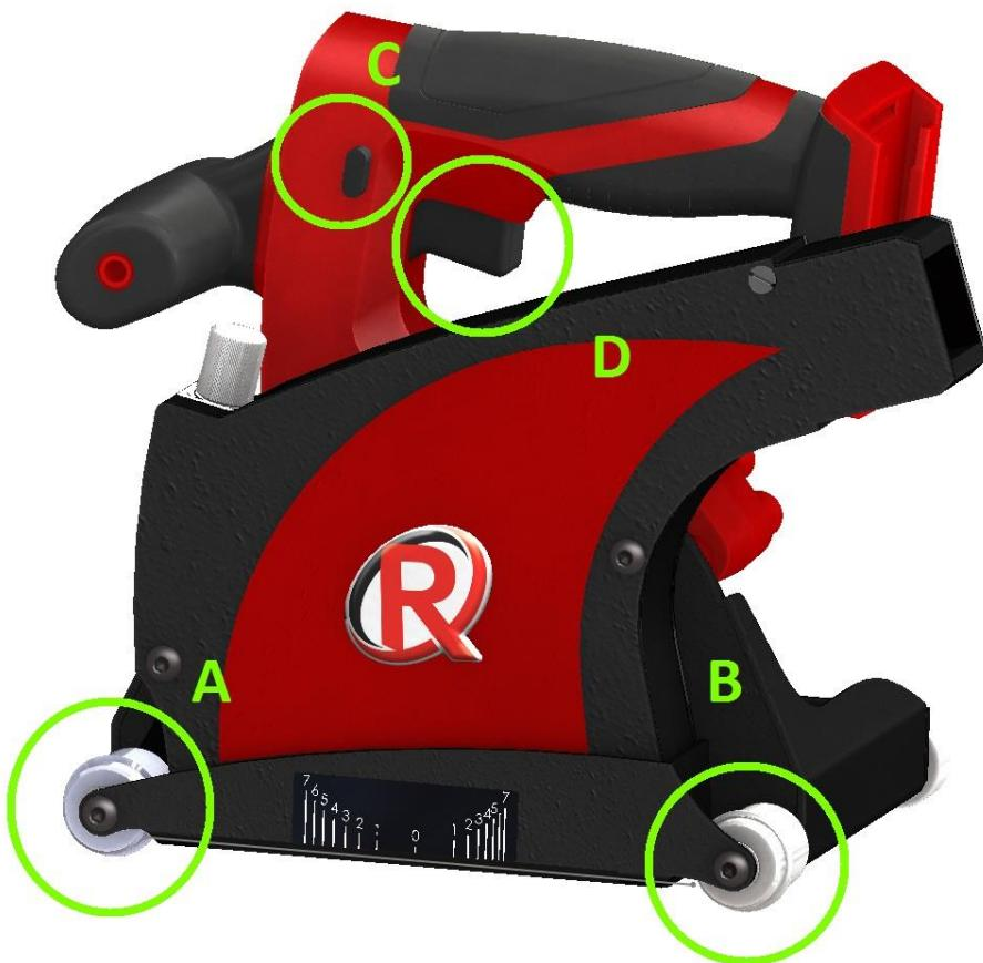
Faire descendre lentement la poignée jusqu'à ce qu'elle soit en butée. Maintenir cette position puis faire avancer la fraiseuse le long du joint. Après quelques centimètres, la roulette-guide arrière (plus large) pénètre directement dans le chanfrein déjà créé, assurant définitivement le guidage de la machine.
