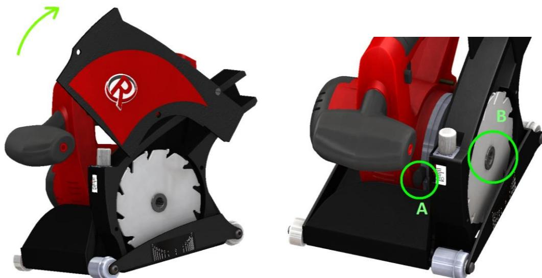
Retirer le pion puis la lame usagée et la remplacer en faisant attention au sens de rotation Positionner le pion (B) en le faisant tourner jusqu'au déclic afin qu'il s'enfonce complètement En appuyant sur le bouton de blocage d'arbre (A), serrer la vis de lame (B) dans le sens antihoraire à l'aide de la clé fournie puis rabattre le capot, revisser les deux vis du capot et ranger la clé dans son logement.
